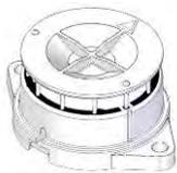
MMS002 は、風速に比例する X、Y 軸のセンサ出力及び、温度センサ値をデジタル出力 (I2C) します。本製品独自の高感度なセンサ素子を採用しており、0~3m/s のわずかな風の流れを検知可能です。AFE 内部にセンサ毎の風速補正パラメータを内蔵しており、本製品データからホストとなる外部マイコンで簡単な演算をすることで風速・風向データを得ることができます。複雑なセンサ駆動/制御回路を必要とせず本モジュールとホストとなる外部マイコンだけで高性能な機器が実現できます。
